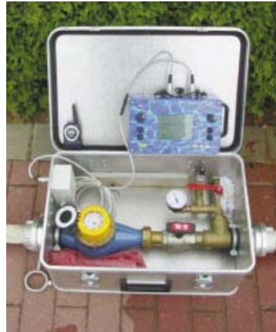
Bild 8: Nullverbrauchs- messung – Druck und Durchfluss, auf dem W.A.S. angezeigt
